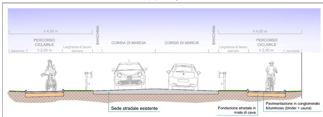
Figura 82 - Piste ciclabili bidirezionali in sede propria con fascia di esproprio a tergo del dispositivo di ritenuta - ambito extraurbano
