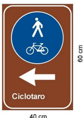
Fig 4: Cartello avviare a itinerario ciclopedonale su viabilità riservata ottenuto da modifiche delle figure 360 - 363 art 136 DPR 495/92
