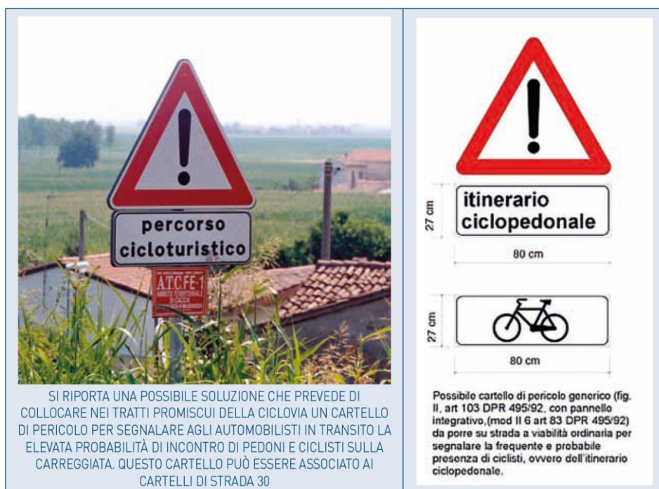
Figura 91 - Segnaletica verticale per percorsi promiscui ciclo-veicolari ("Vademecum della ciclabilità" - Regione Puglia)
