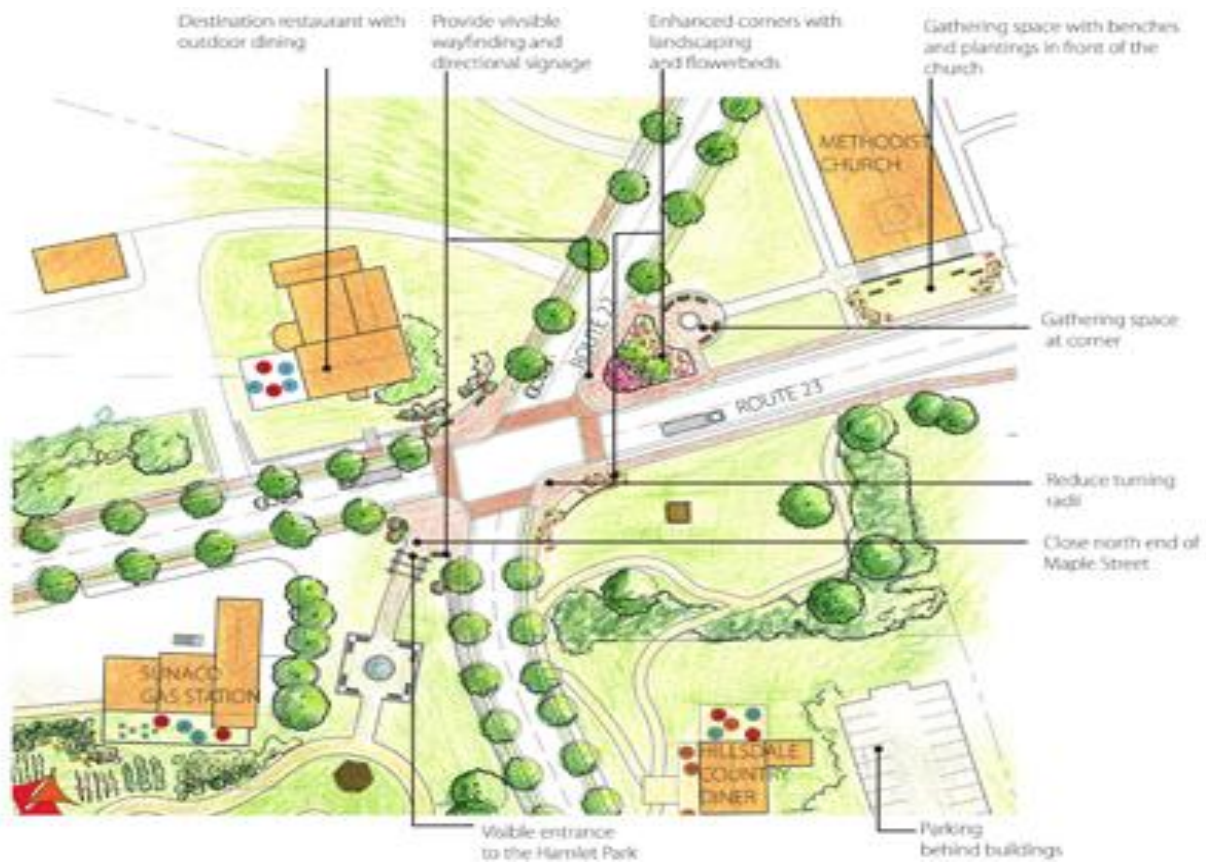
Figura 125 - Esempio di sistemazione di una Zone 30 con porte di accesso (fonte: https://nyc.streetsblog.org/2007/02/19/dot-pledged-pedestrian-safety-fixes-for-third-avenue-by-2006/ )
