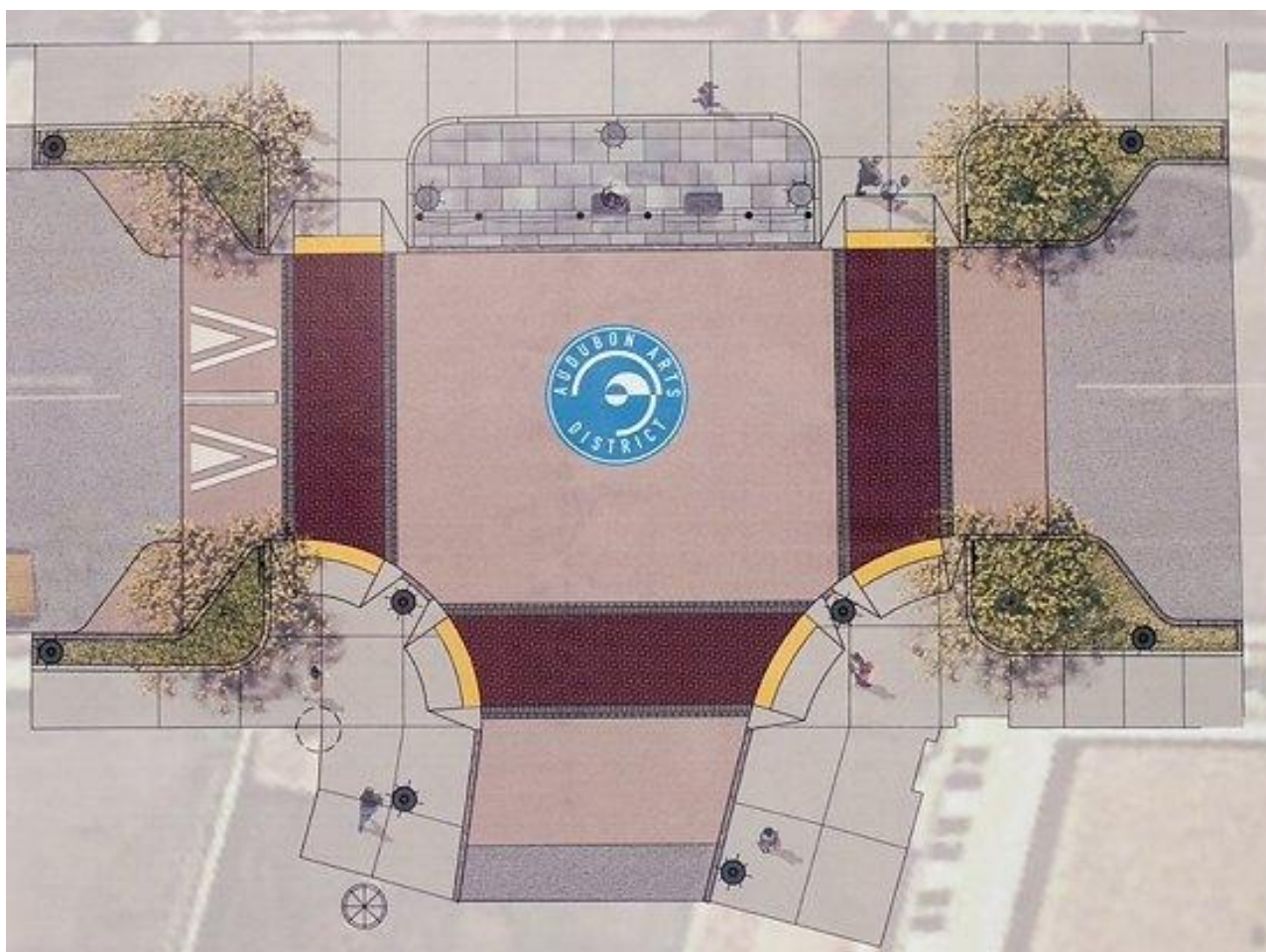
Figura 115 - Esempio di intersezione rialzata (fonte: https://usa.streetsblog.org/2013/08/27/guerrilla-crosswalk-turns-into-total-overhaul-of-new-haven-intersection/ )
