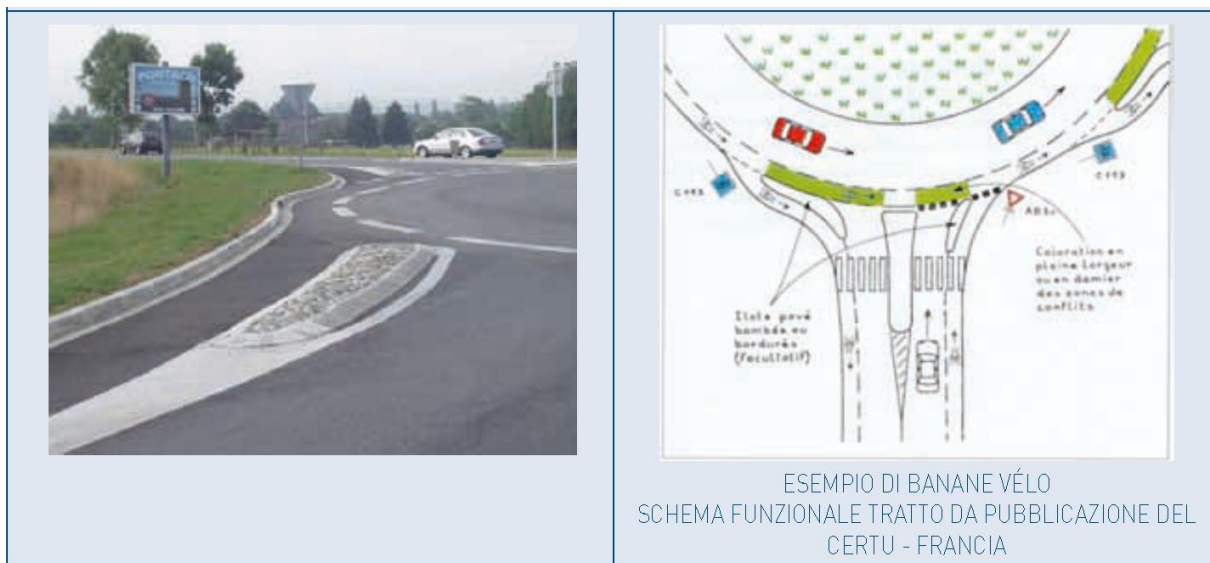
Figura 104 - Esempi di rotonde realizzate con Banane Vélo (Vademecum della ciclabilità - Regione Puglia)
